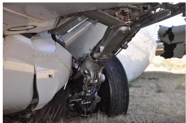
A319 EI-EDM: particolari della semiala sinistra e del relativo carrello.
