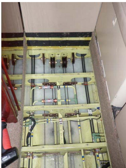
P180 marche di immatricolazione N140SL: prove sul sistema di cavi e pulegge della trasmissione dei comandi.
