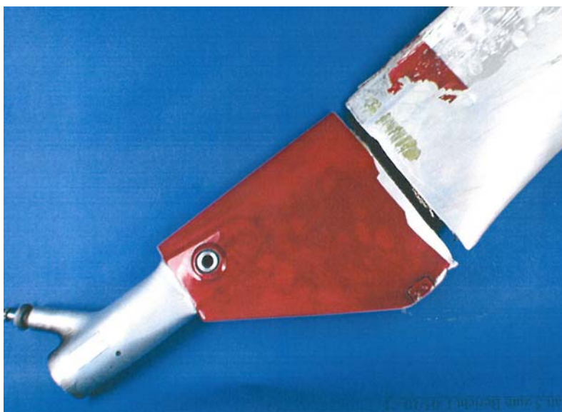
Rottura della pala del rotore di coda P/N 109-0132-02-121.
