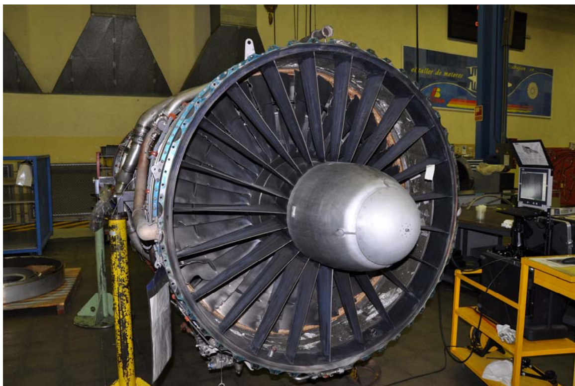
Ispezione sul motore di un MD-82 danneggiato da birdstrike .
